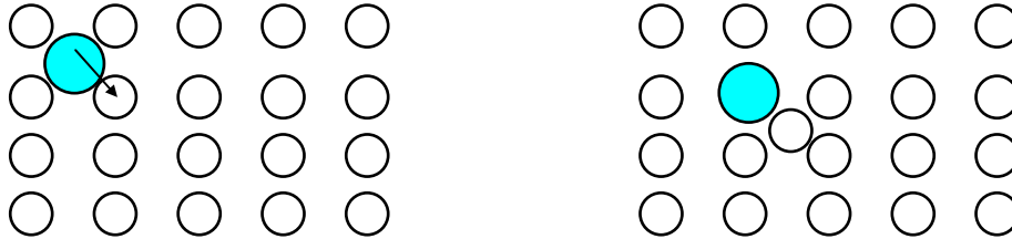
Figure 73: L'interstitiel saute sur une position de substitution et chasse l'atome présent qui se trouve alors comme autointerstitiel.
