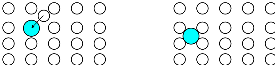
Figure 74: Un interstitiel arrive à son voisinage et repousse l'atome étranger sur une position interstitielle en prenant sa place.
