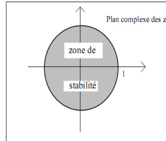
Un filtre numérique est dit causal, si sa réponse impulsionnelle  $h_n$  est nulle pour  $n < 0$ . Sa transformée en  $z$  converge alors à l'extérieur d'un cercle.
