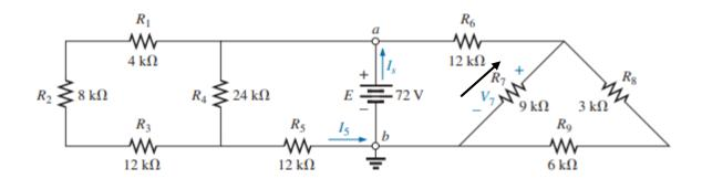
Given:  $R1=4K\Omega$ ;  $R2=8K\Omega$ ;  $R3=12K\Omega$ ;  $R4=24K\Omega$ ;  $R5=12K\Omega$ ;  $R6=12K\Omega$ ;  $R7=9K\Omega$ ; E=72V.
