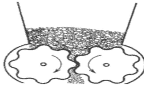
BROYEURS A CYLINDRES CANNELES
