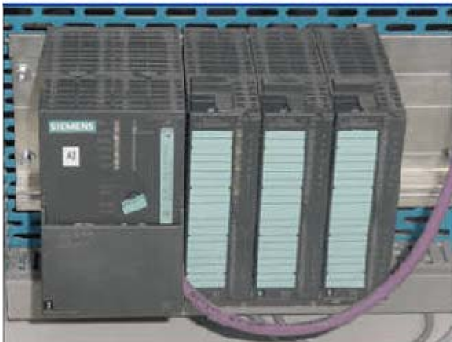
Fig.I.2: Exemple d'une architecture réelle d'un API-300
