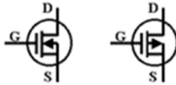
Figure 12 : Symboles de D-MOSFET : a) D-MOSFET à canal N, b) D-MOSFET à canal P
