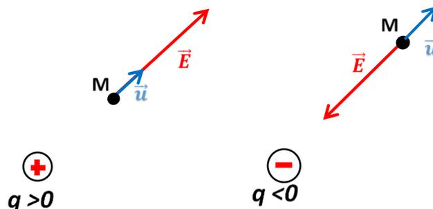
Figure I-10 : Champ électrique créée par une charge ponctuelle.
