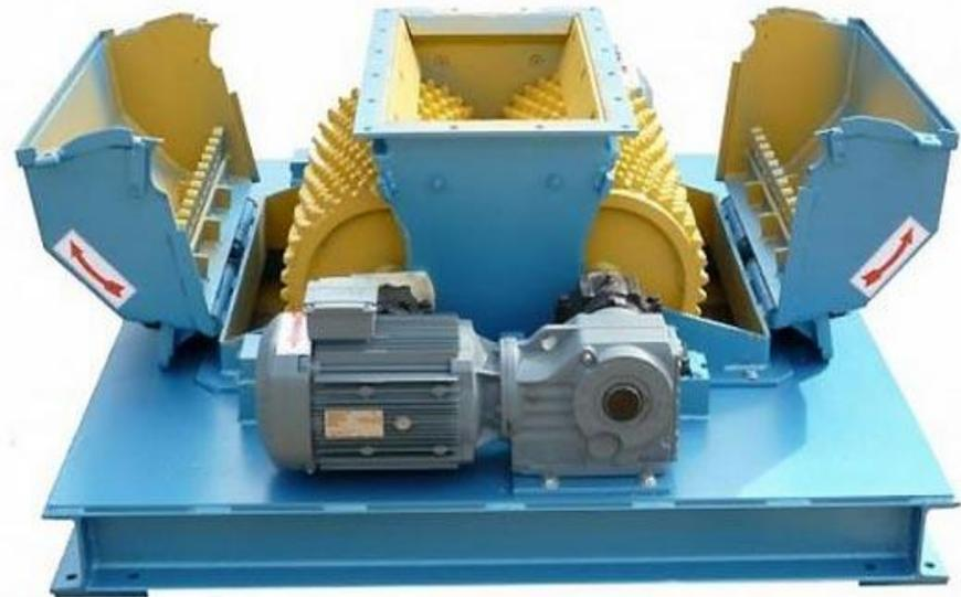
**BROYEURS A CYLINDRES CANNELES**
