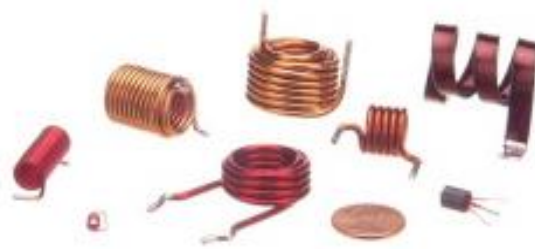
Figure 3. 1 : Bobines à air
