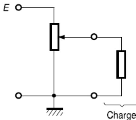
Figure 1. 14: Résistance variable montée en potentiomètre
