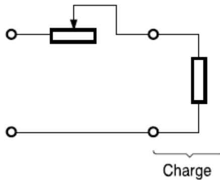
Figure 1. 13: Résistance variable montée en rhéostat
