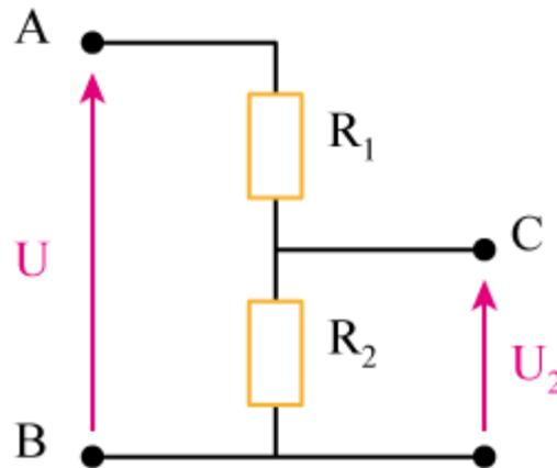
Figure 1. 10 : Circuit diviseur de tension
