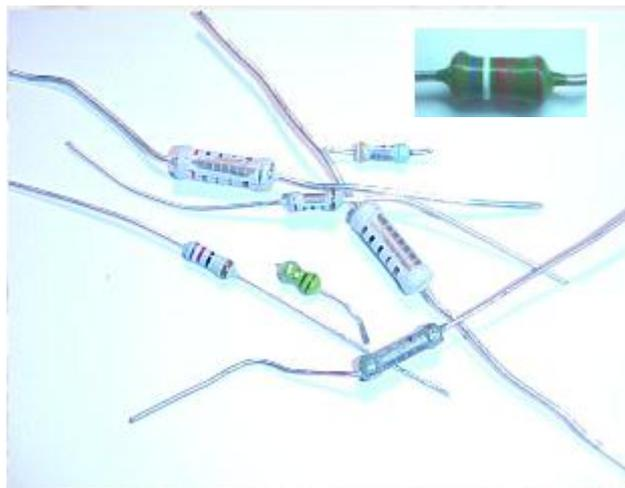
Figure 1. 3 : Résistance à couche métallique
